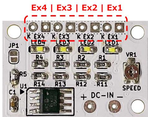
Ex1, Ex2, Ex3, Ex4はそれぞれ、LED1, LED2, LED3, LED4の点滅と同じタイミングで点滅します。
