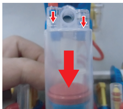
ピストンを抜く時 エアバルブは下の方に動く
